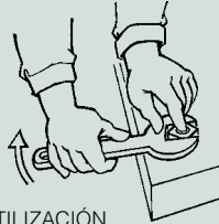
UTILIZACIÓN CORRECTA DE LLAVE GIRANDO HACIA EL OPERARIO
